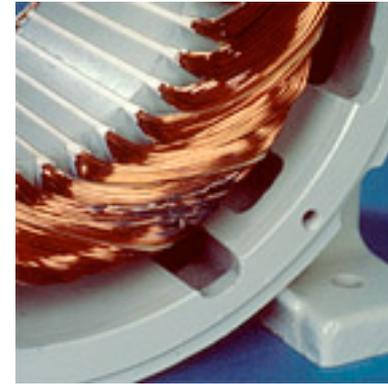
Enroulements avec bobine court-circuit.
