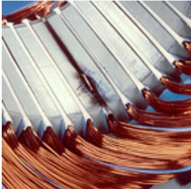
Court-circuit au connexion des groupes d'enroulements.
