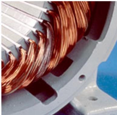
Enroulements court-circuit au bord de l'encoche.
